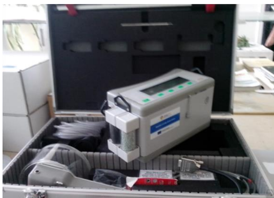
Figura 8. Aparatul utilizat pentru măsurarea respirației solului (ADC BioScientific Ltd – LCI, Marea Britanie) în cadrul experimentului de lungă durată Livada
